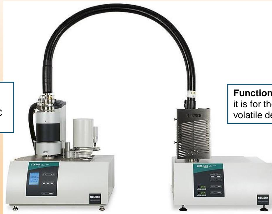
**NETZSCH STA 449 F3 Synchronous Thermal Analyzer Jupiter® (NETZSCH Gerätebau GmbH, Germany)**
