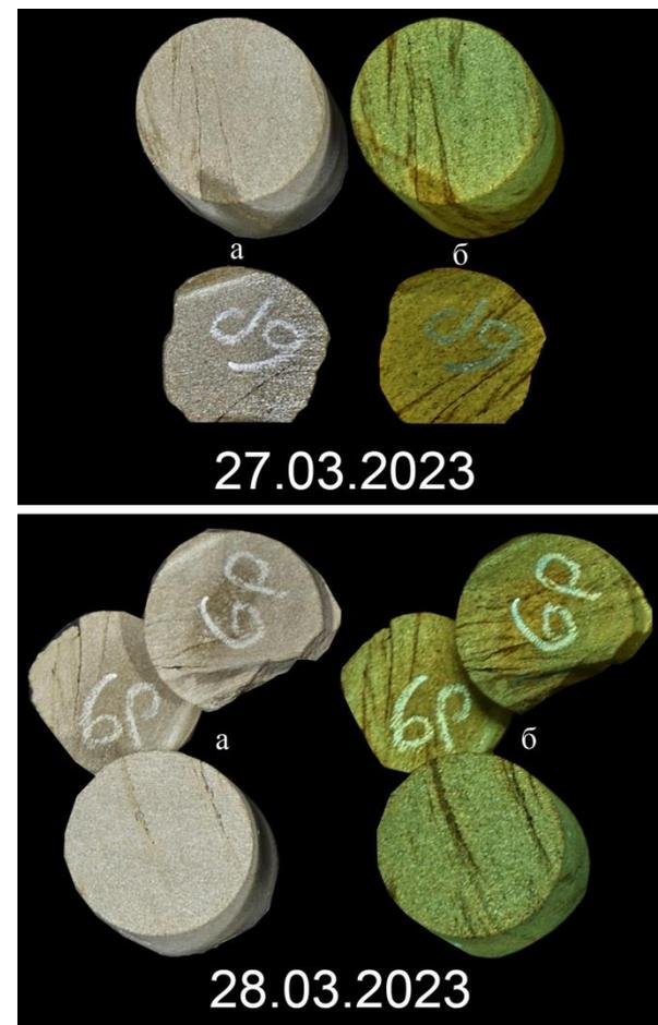
Рисунок 24. Пример тушения и восстановления цветности люминесценции нефтенасыщения в песчанике при наличии воды. Фотоизображения образцов песчаника в ДО (а) и УФО (б)
