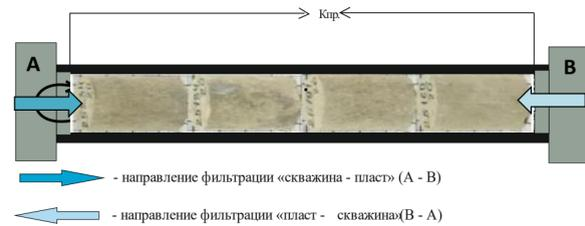
Фильтрация нефти до и после растворов велась по схеме «пласт-скважина», закачка растворов - в направлении «скважина - пласт» в количестве 1-2 объемов пор. После чего модель выдерживали без фильтрации в течение 3 ч. Водонасыщенность модели после эксперимента определялась методом азеотропной перегонки с толуолом.
